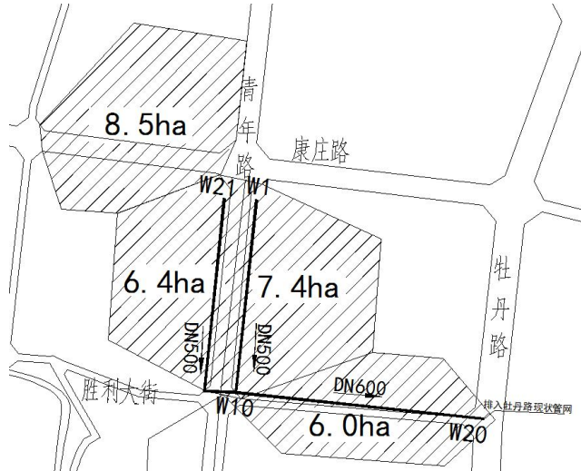
图 2.污水管道汇水范围图
